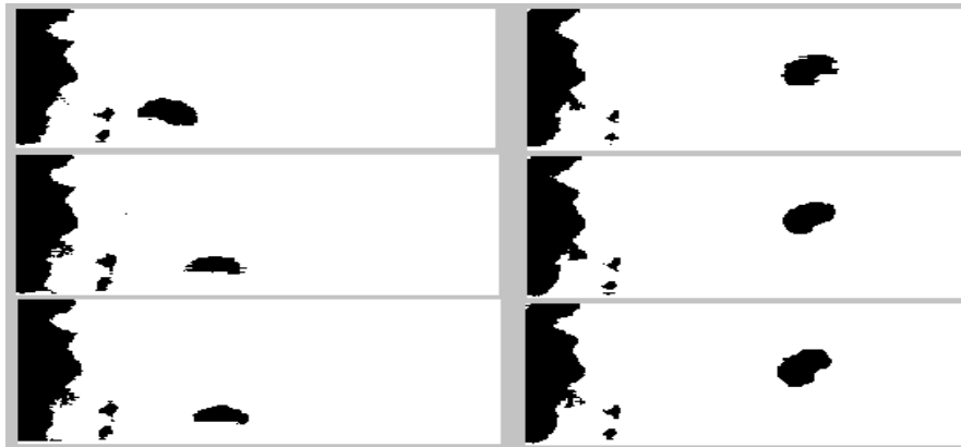
Figura 9. Sustracción de fondos con aplicación de umbral
