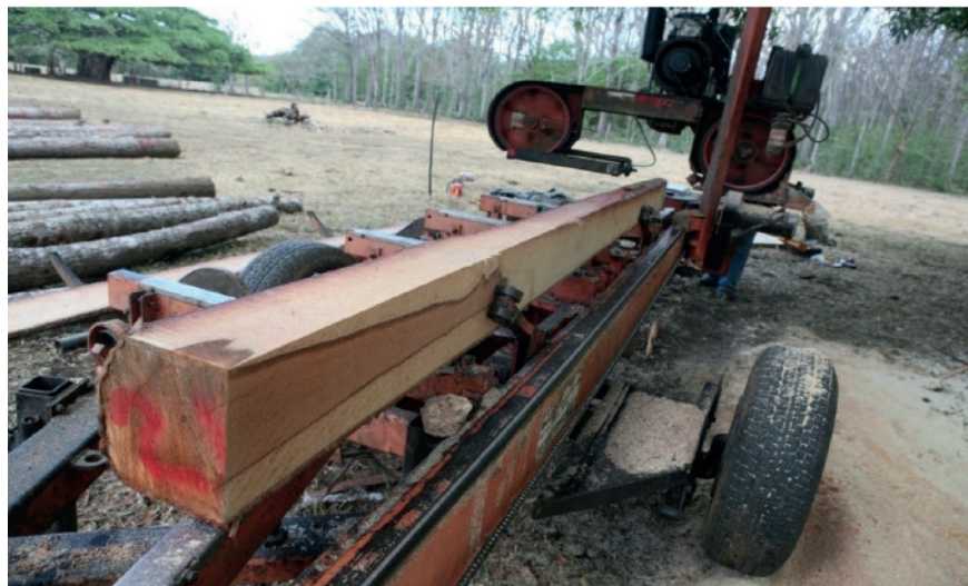
Figura 2. Aserradero portátil Wood-Mizer, modelo LT-40, utilizado para aserrar la madera proveniente de un raleo en una plantación de Pachira quinata , a los 32 años de edad, en la zona de Nicoya, Guanacaste, Costa Rica.
