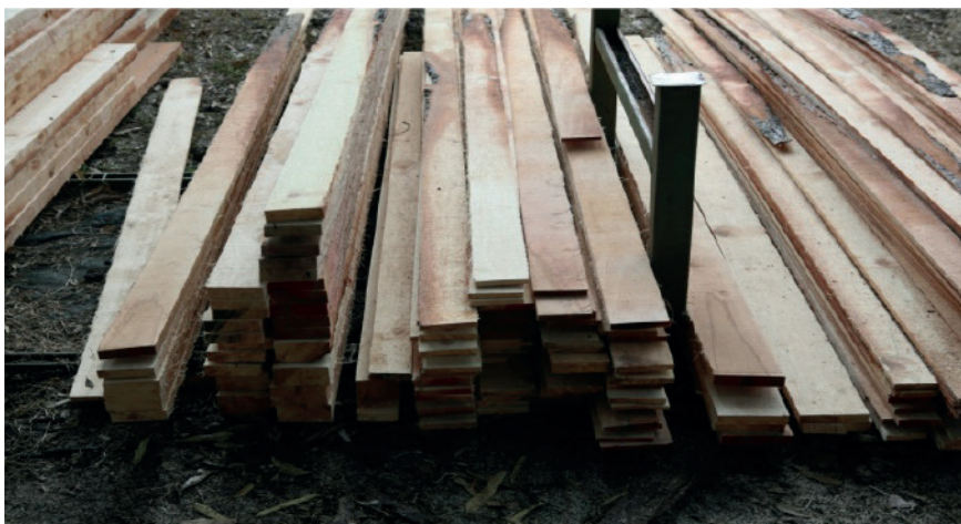
Figura 4. Diferentes productos obtenidos en la fase de aserrío provenientes de un raleo en una plantación de Pachira quinata , a la edad de 32 años, en la zona de Nicoya, Guanacaste, Costa Rica.
