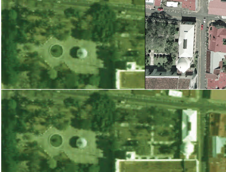
Figura 10: Visualización del desplazamiento aparente de los objetos en la imagen georeferenciada comparada con el mosaico de ortofotos, escala 1:5000, disponible en el SNIT.
