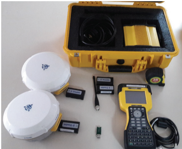
Figura 1: equipo Trimble® R4 GNSS y controlador TSC2.
