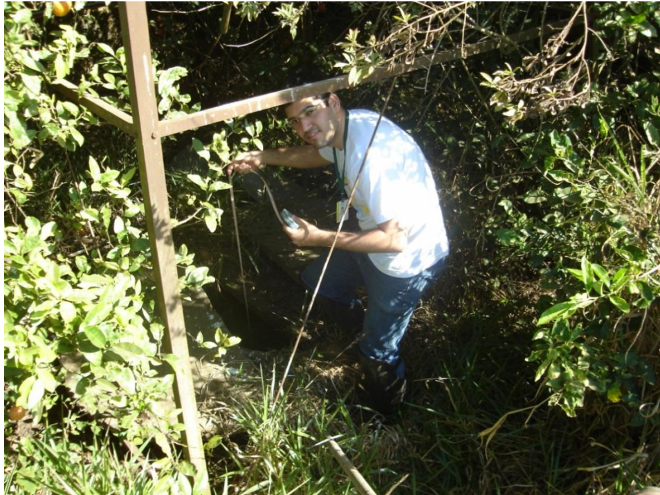
Figura 3. Utilização de cisternas (poços) para monitoramento no N.A. Autor: DANTAS, A. R. 2010
