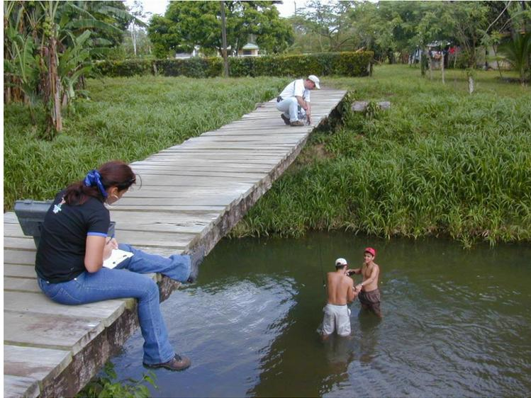
**Foto 8: Determinación de caudal en sección de aforo Río Guacalito**
