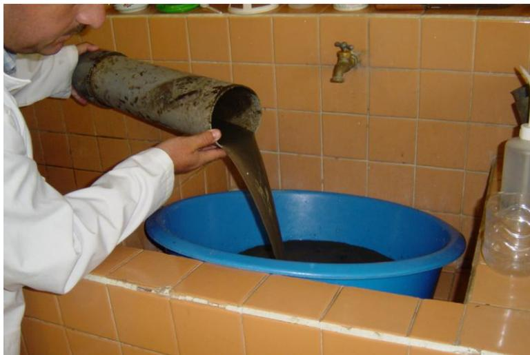
**Foto 9: Extracción de material contenido en los botes de sedimento suspendido**
