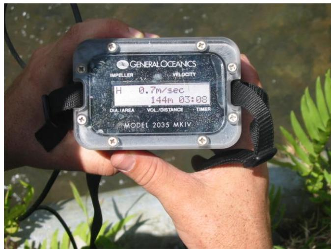
**Foto 7: Correntómetro *General Oceanics 2035* para determinación de velocidad de flujo superficial**
