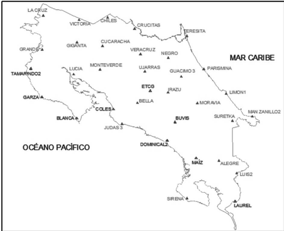
Figura 2. Ubicación de los puntos de la red geodésica de primer orden usados en el proyecto en la proyección CRTM05. Se presentan los siete puntos en el litoral pacífico y los dos puntos de la parte central del país
