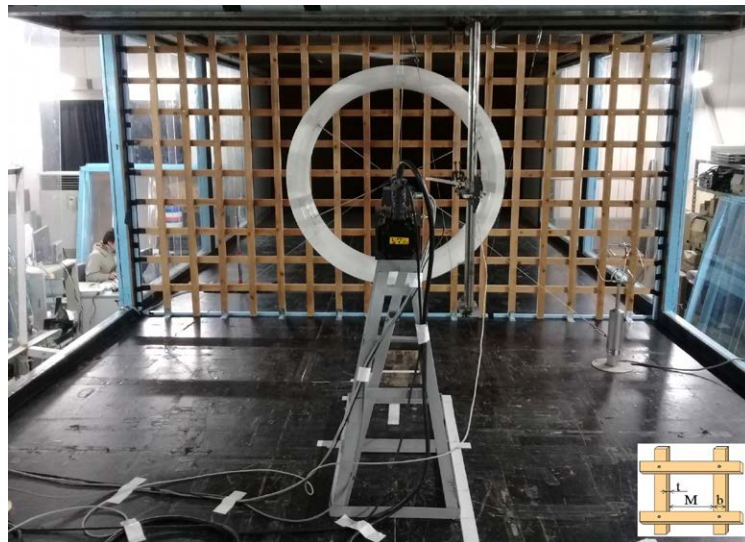
Figura 2. Rejilla para generación de turbulencia. Elaboración propia de la investigación.
